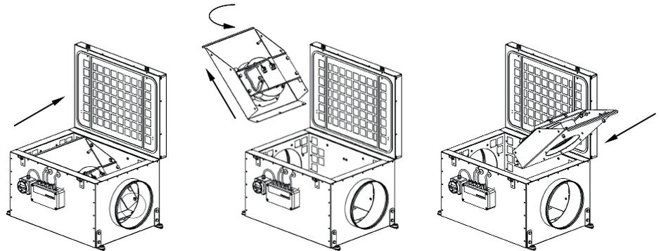
**Lüftungsgeräte RV-A30.1 / RV-A40.1 / RV-A50.1:** Bei diesen Lüftungsgeräten steht die Innenwand mit dem Motor nicht schräg wie hier abgebildet sondern senkrecht!
