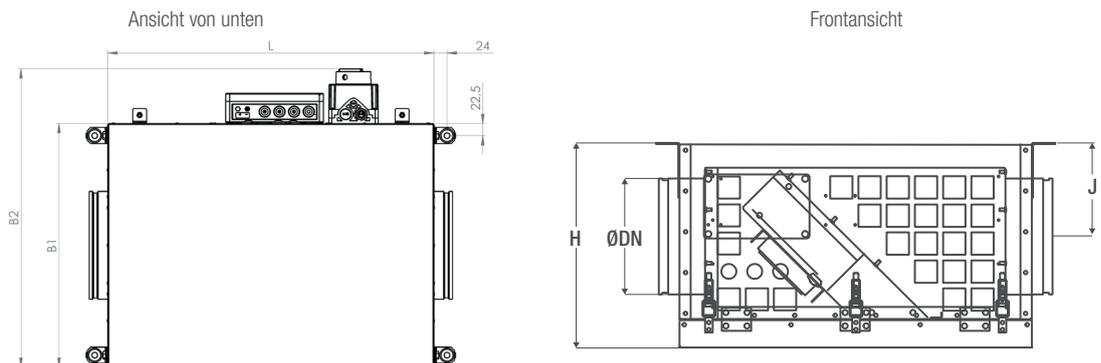
Die Darstellung zeigt den Ventilator in Deckenmontage, dieser ist jedoch in jeder beliebigen Einbaulage montierbar. Die Luftfrichtung kann auch nach Einbau durch das Drehen des Motors um 180° geändert werden.
