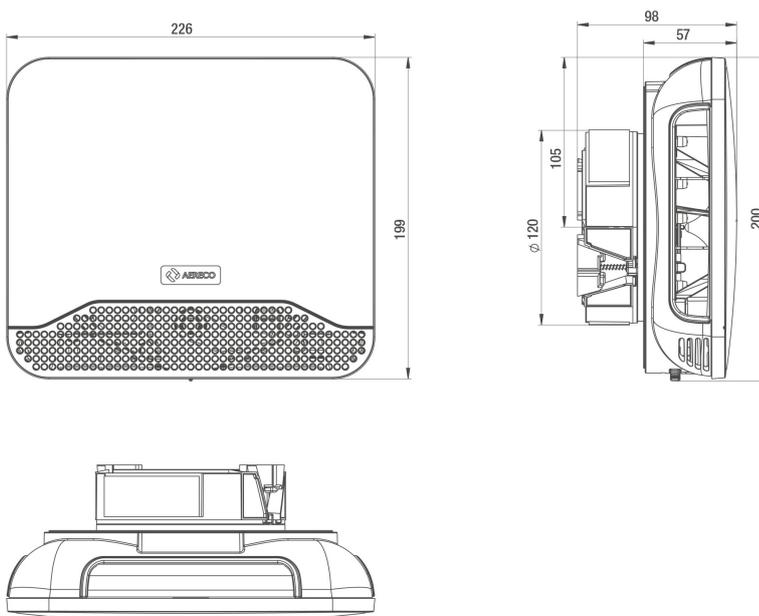
KWK 04 (Ohne Putzschutzabdeckung und Schalldämmeinlagen dargestellt)
