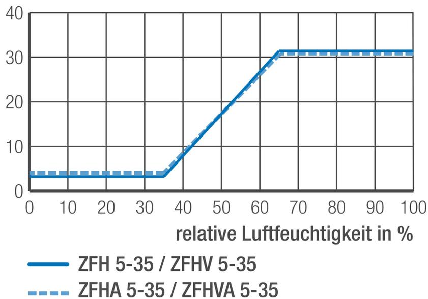
Nach DIN 1946-6 wird als  $q_v$ , ALD der max. hygrometrische Volumenstrom für die Berechnung angesetzt. Die Werte bei 10 und 20 Pa haben lediglich Orientierungscharakter. Differenzdrücke zur Auslegung der ALD nach DIN 1946-6:2019-12: Freie Lüftung nach Formel 24 oder Tabelle 13 / Ventilatorgestützte Lüftung nach Tabelle 19 dieser Norm.
